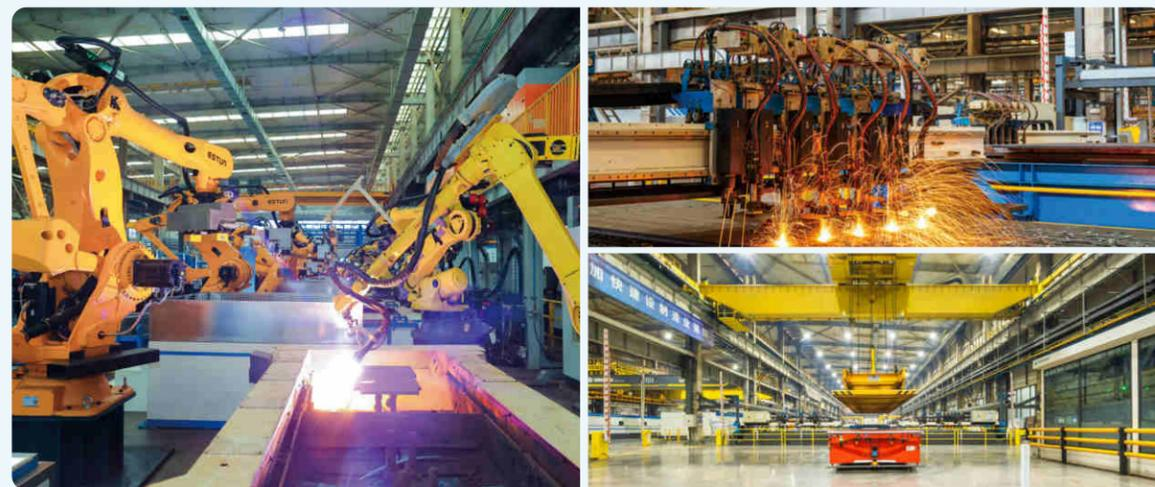
同时，高科技设备高效运转，大幅减少人力成本，显著提升生产效率和产品质量。智慧园区共有23条智能化生产线，近200台不同类型的机器人分布在各个生产线上，包括独家研发的抓手式无人智能行车、业内首次应用的大型变位机、14台高速高功率光纤激光切割机等，实现产量提升30%以上，人效提升100%以上，生产周期由原来的28天缩短至9天。
