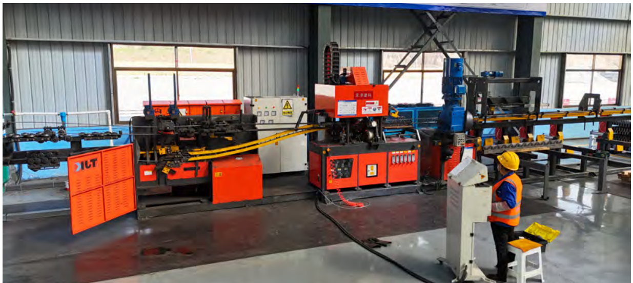
钢筋自动焊接
